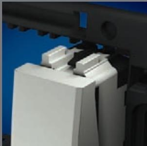
■ **Mecanismos robustos** e compactos, que são inseridos frontalmente de uma forma intuitiva, fácil e sem interferências. O exclusivo sistema guiado da linha STEP permite também a extração frontal dos mecanismos, sem a necessidade de retirar o suporte da parede. Reduziu-se a profundidade do mecanismo para facilitar a fixação. Um passo à frente em facilidade de instalação.
