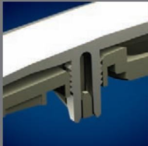
■ As placas têm flanges com desenho de **dente de serra**, com ajuste em 3 posições que permitem regular a altura da placa até 3 mm. As flanges são compostas por sistemas de 2 encaixes – 2 por flange –, para assegurar a montagem dos interruptores e placas, independente de qualquer imprevisto ou imperfeições na parede.
